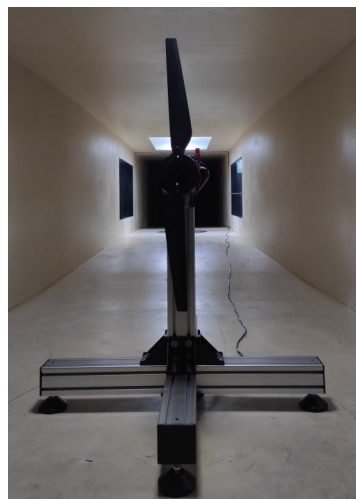
图 10 风洞中的螺旋桨(直径 0.61 m)
