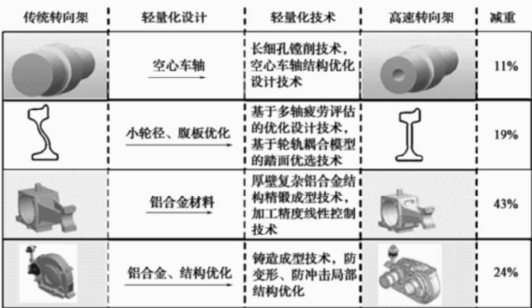
图 20 高速转向架簧下质量轻量化措施及效果
