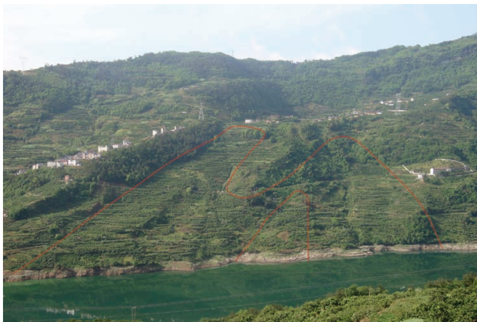
图3 (网络版彩色)相机采集到的原始图像. 实线部分内是滑坡和次级滑坡体范围
