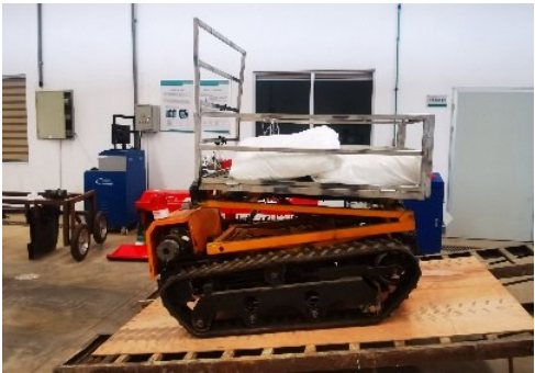
图11 调平测试 Fig.11 Leveling test
