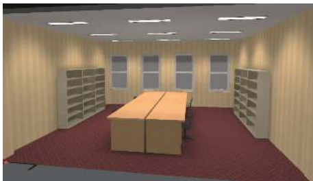
图4 DIALux 软件中建筑物内照明设计效果图
