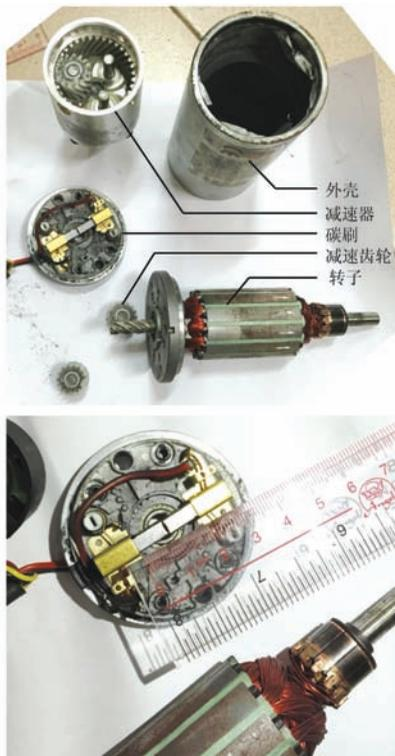
图 3 电机拆解评估状态
