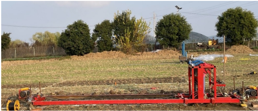
图5 小区精密播种试验台架 Fig.5 Plot precision seeding test bench
