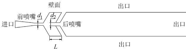
图 2 自激振荡喷嘴计算模型
