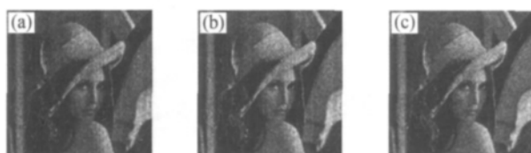
(a) 芯片 ADC 噪声图像; (b) 列 ADC 噪声图像; (c) 像素 ADC 噪声图像.
