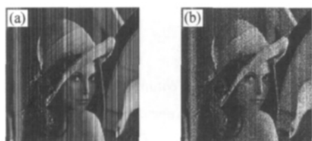
(a)添加 10%FPN 图像;(b)经动态列开关电路处理后的噪声图像。
