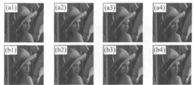
(a1)、(b1)为未添加噪声的原始图像;(a2)、(a3)、(a4)分别对应添加一般噪声估值下 V'_{ijt} 、 V''_{ijt} 、 V'''_{ijt} 的输出,此时,时间噪声、FPN 分别取为 0.35\% 、 0.68\% ;(b2)、(b3)、(b4)则分别为添加大噪声估值下 V'_{ijt} 、 V''_{ijt} 、 V'''_{ijt} 的输出,时间噪声、FPN 分别取 3.9\% 、 5\% 。
