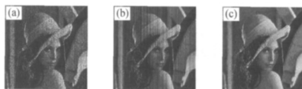
(a) 添加各级 FPN 图像; (b) 添加像素 FPN 抑制电路后的结果; (c) 为在(b)基础上添加列 FPN 抑制电路后的输出.
