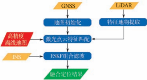
图 6 基于特征地物地图的融合定位算法
