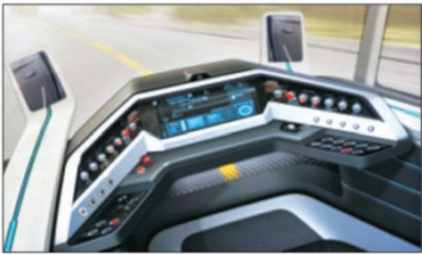
图 19 未来智轨电车司机控制台 Fig.19 Driver's console for future autonomous-rail rapid tram 5.2 HUD 显示
