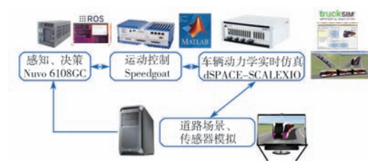
图 14 HIL 测试平台 Fig.14 HIL testing platform
