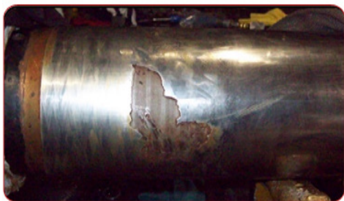
(a)轴杆表面陶瓷涂层脱离
