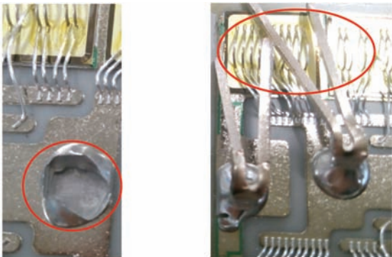
(a) 改进前断裂点在焊点 (b) 改进后断裂点在母排上 图 13 改进前、后断裂点位置 Fig.13 Break points before and after optimization
