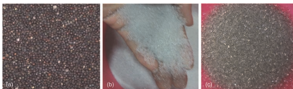
图 2 (网络版彩色)3 种测试颗粒实物图。(a) 油菜籽(1.7~2.3 mm); (b) 玻璃微珠(0.4~0.6 mm); (c) 玻璃微珠(0.8~1.2 mm)
