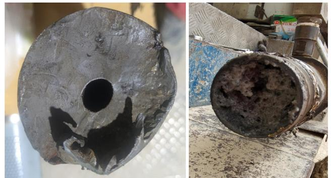
图 2 涩北疏松砂岩气田开采过程中出砂照片
