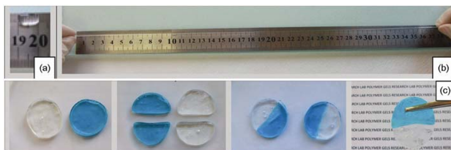
图 5 两亲脂肪链自愈合凝胶(PAAm-co-C18)拉伸前(a)和后(b)的照片及愈合过程照片(c)(亚甲基蓝染色, 切开凝胶然后将断面挤压在一起后凝胶愈合) [52]
