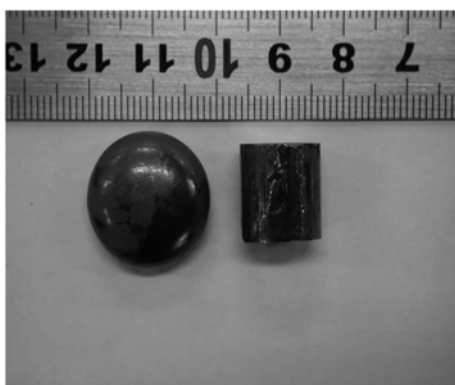
图 1 饵基非晶的实物图(左边是非晶的母合金, 右边是非晶样品)
