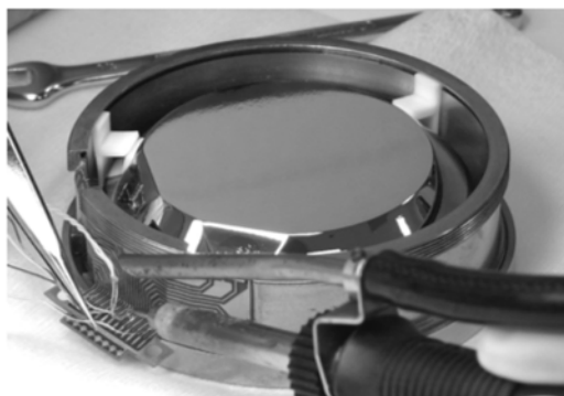
图 6 低温量热高纯锗探测器工作原理示意图和单个探测器内部结构
