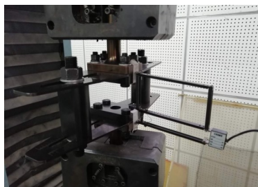
图 8 刚度模拟器测试试验与引伸计的安装
