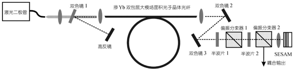
图2 双包层大模场面积光子晶体光纤飞秒激光器实验装置图
