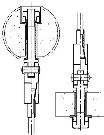
图1 销接式拉索锚具图
