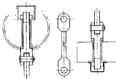
图2 销接式刚性拉杆锚
