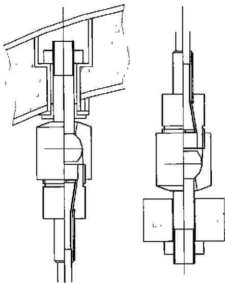
图4 球铰式拉索冷铸锚具图
