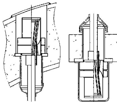
图3 球铰支座拉索冷铸锚具图
