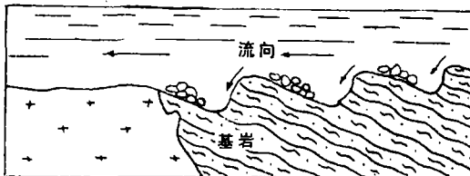
图 7 谷底基岩的片理、裂隙对金粒阻留示意图
