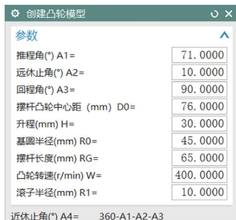
图 7 创建凸轮模型对话框
