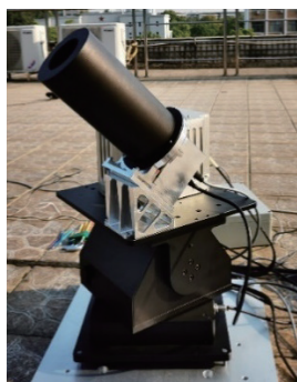
图 9 星体跟踪式星敏感器实验系统
