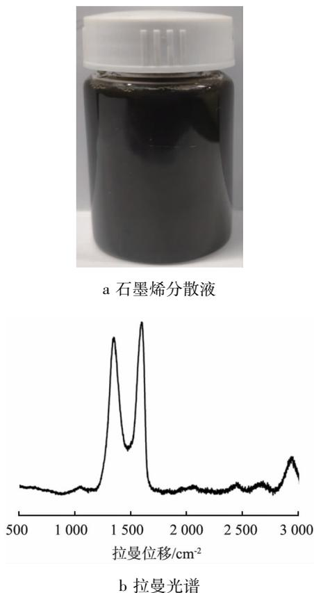
图 6 石墨烯分散液的照片和拉曼光谱
