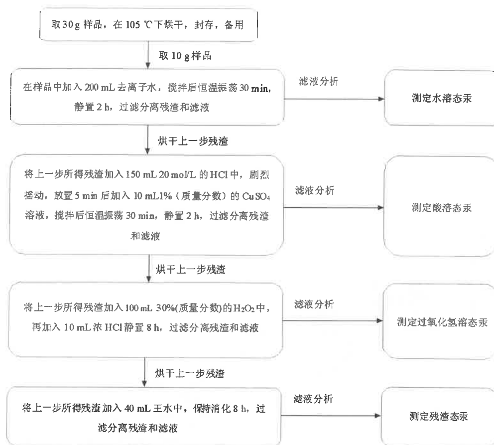
图1 造纸白泥样品中不同形态汞的分级浸提步骤
