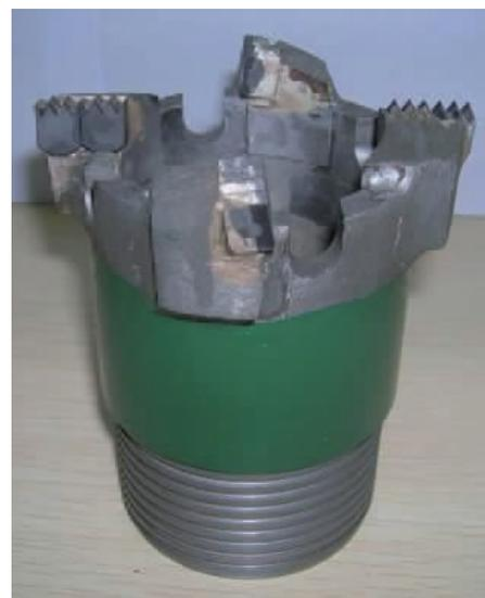
图 11 细齿状复合片钻头
