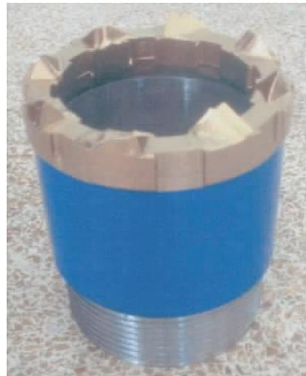
图 10 尖齿状复合片钻头
