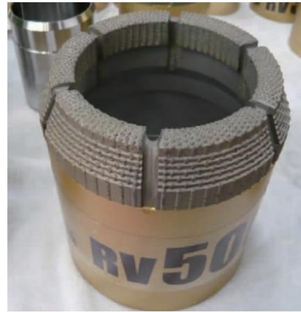
图 5 Sandvik 表镶金刚石钻头
