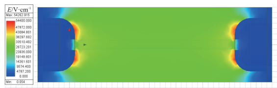
图 2 电极间距 150 mm 时的电场分布
