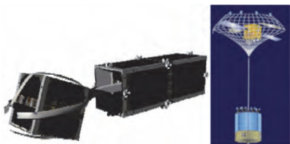
图 23 (网络版彩色)空间拖船追赶抓捕碎片技术示意图
