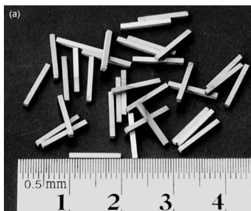
图 1 BST 小柱和棱镜折射法示意图
