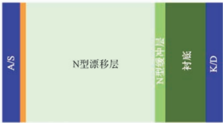
(a) 具有平行平面 P^+N 结的理想漂移区模型
