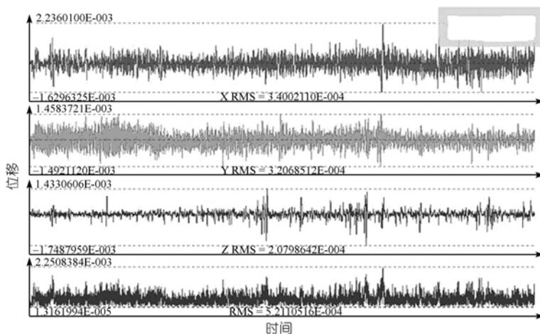
图 10 下平台控制精度
