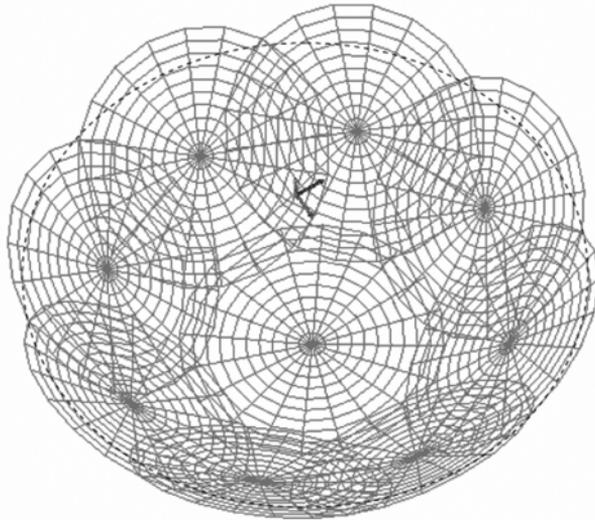
图 4 主动反射面数码扫描分区示意图
