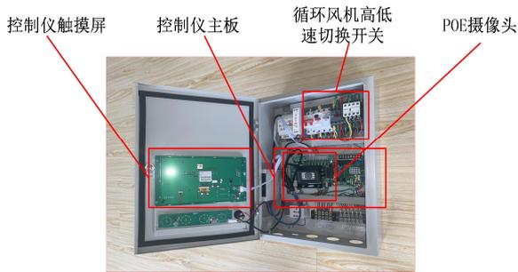
图1 物联网智能烘烤控制仪
