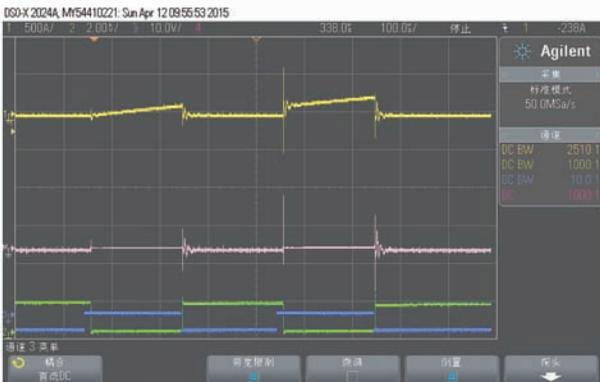
图 4 国产 IPM 模块双脉冲试验下管波形
