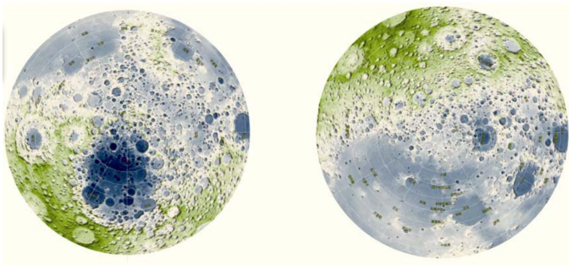
图 11 由激光高度计数据绘制的全月球 DEM 图
