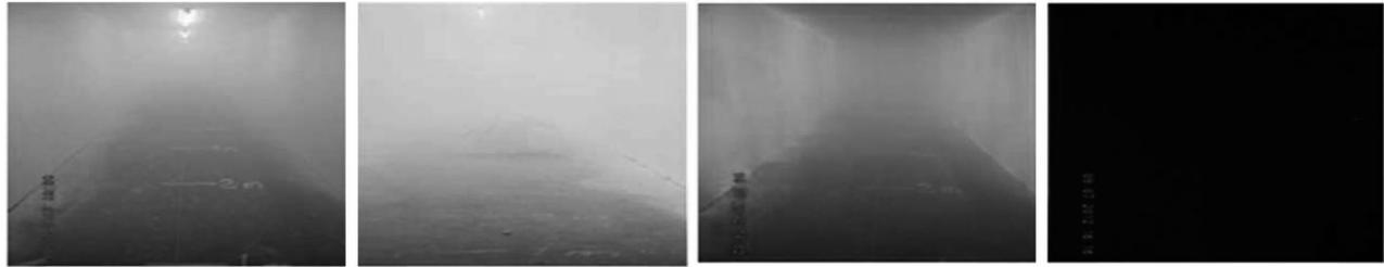
(a) 蓄能发光多功能材料(开灯) (b) 墙体涂装普通材料(开灯) (c) 墙体涂装蓄能发光多功能材料(关灯) (d) 墙体涂装普通材料(关灯)
