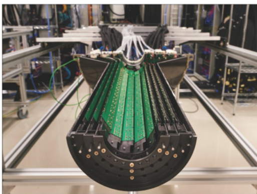
图1 (网络版彩图) STAR实验PXL探测器(上) [4] 和ALICE实验ITS探测器的内半筒结构(下)
