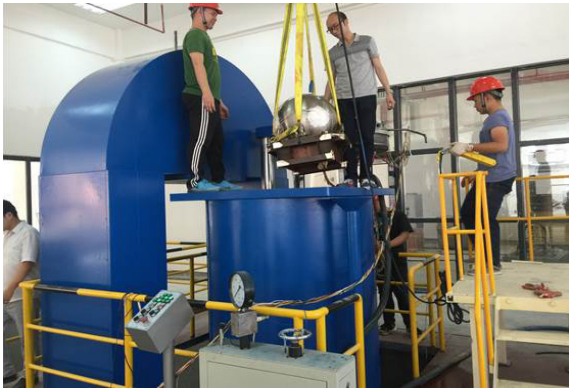
图 3 钛合金载人球舱缩比件静水外压试验
