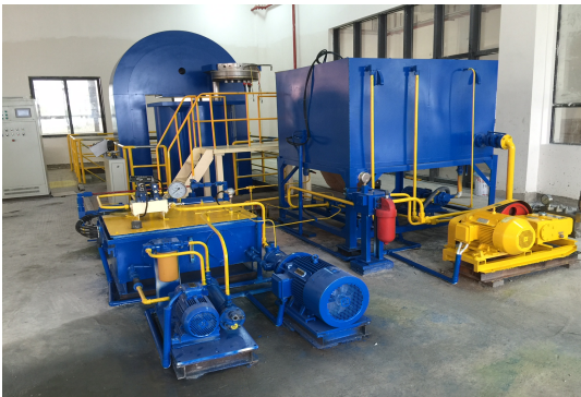
图 2 中科院深海所与川西公司联合研制的 200MPa 中型超高压试验装置
