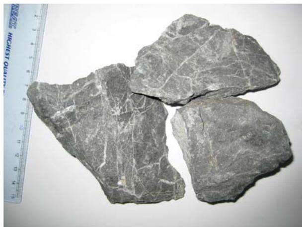
图 3 变质石英杂砂岩金矿石手标本(DGL045)
