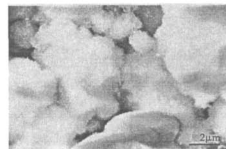
(b)pH=12 环境下水解 SEM 显微图
