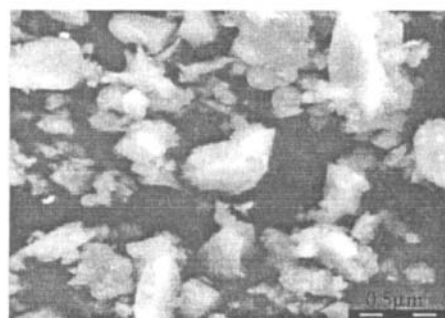
(b) AlN 原始粉末 SEM 显微图
