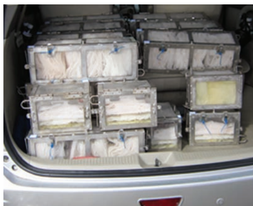
图10 (网络版彩色)提铀装置与无纺布功能材料实物图
