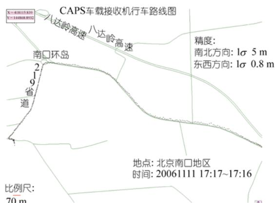
图 14 CAPS 精码接收机北京八达岭车载导航、定位试验
