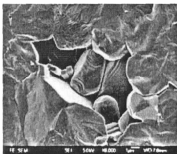
图 3 1350℃/2 h 烧结的 \text{BaZr}_{0.35}\text{Ti}_{0.65}\text{O}_3 陶瓷的 SEM 图
