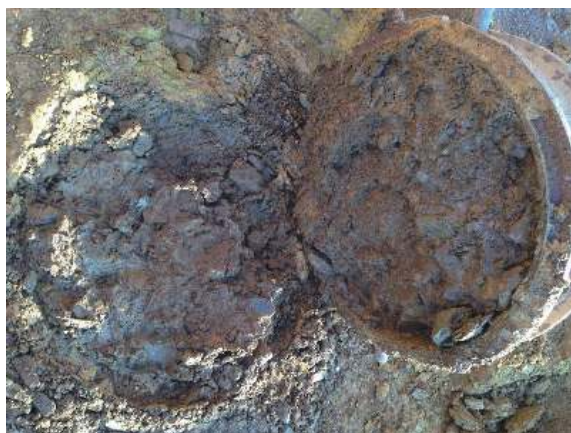
图 13 单环剪切仪得到的典型剪切破坏面
