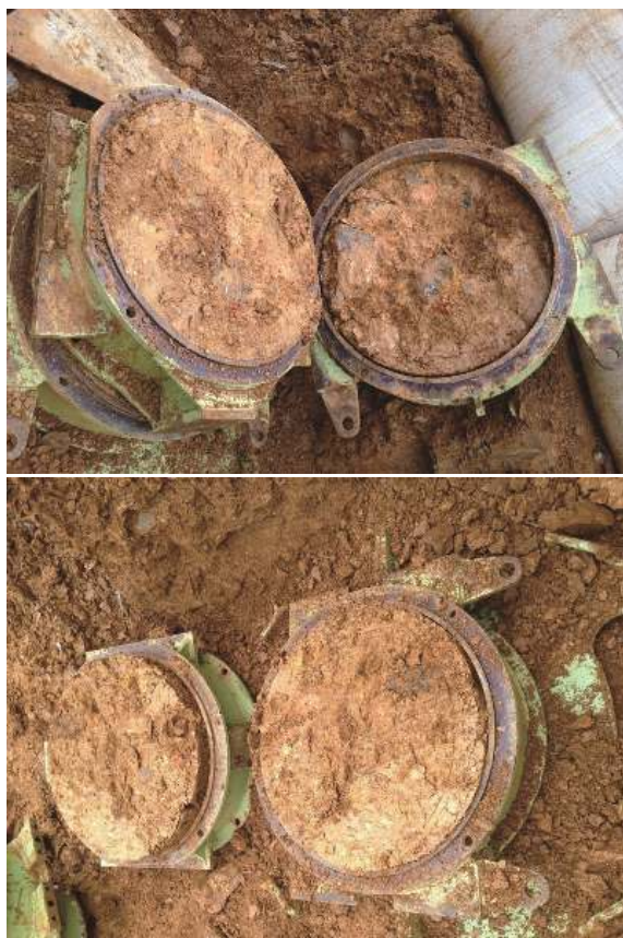
图 14 自反力双剪面大型剪切仪得到的典型剪切破坏面
