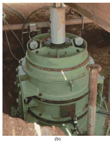
图 6 双剪面自反力大型原位直剪仪正视图 (a) 及实体仪器 (b)
