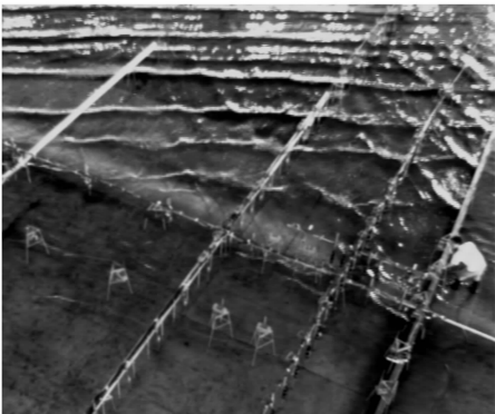
图3 实验4反射壁附近的波浪叠加
