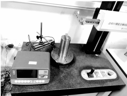
图 11 刚度试验测量示意图
