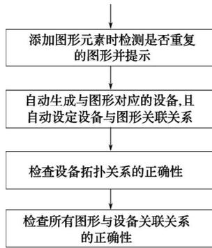
图3 完整性一致性检查的算法流程
