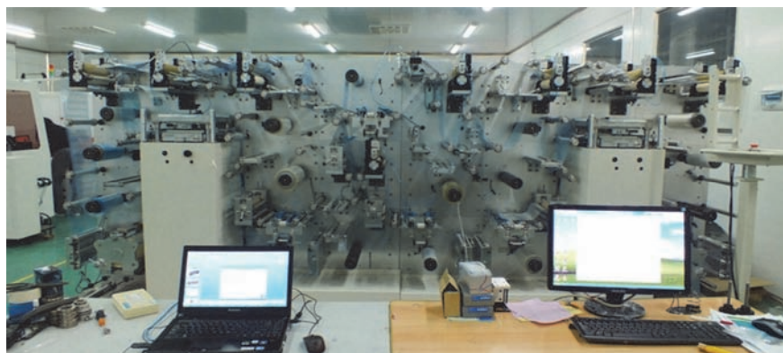
图5 (网络版彩色)燃料电池膜电极密封膜卷到卷叠层装备
