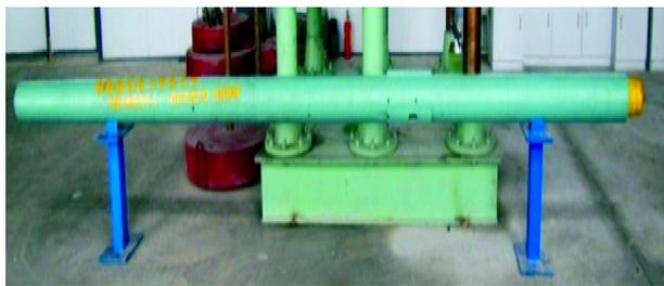
图 4 随钻地层压力测量装置实物图
