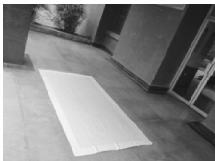
图 4 利用矩形定标物建立相机与参考平面的空间关系
