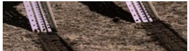
图4 转移机构末端月壤溢出照片
